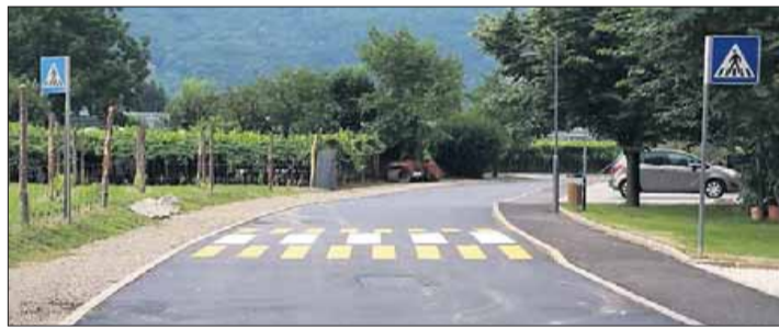
Die Bremschwelle soll Autofahrer zum Verlangsamten zwingen.
